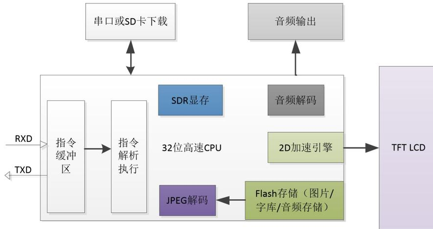
图 10-1 M 系列串口屏内部结构图
