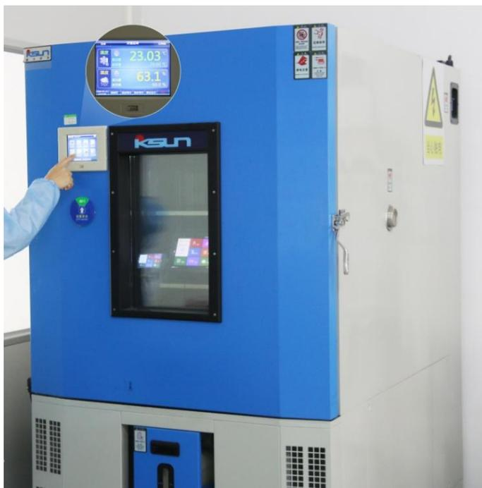
图 5-3 高低温老化测试图
